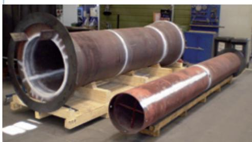
**Dampfsieb aus 16 Mo 3 gebohrt DN 600**
